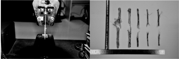
图 2 柠条锦鸡儿单根断裂模式
