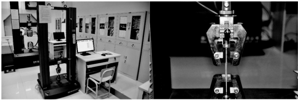
图 1 单根拉伸试验仪器与试验过程示意图
