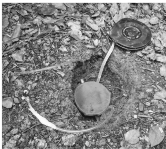
图2 土壤水分采集器与渗漏液采集器示意图
