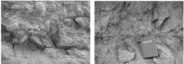
三门组黏土滑带 三趾马红土滑带 图 1 渭北黄土塬边大型滑坡滑带地层
