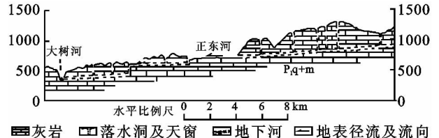
图 2 研究区叙永县正东附近阶梯状岩溶管道流示意图
