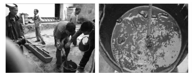
图 2 矮子沟泥石流容重现场配样法
