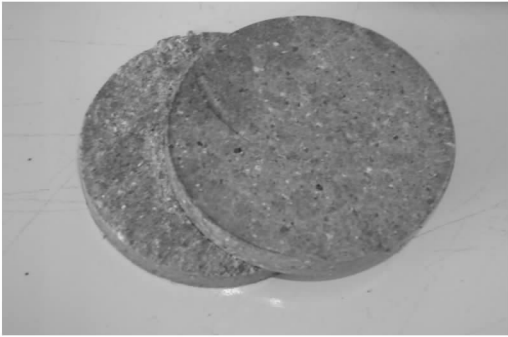
图 2 剪切后破坏的试样
