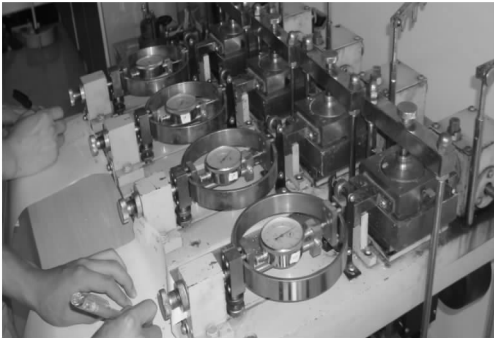
图 1 四轴联动应变控制式直剪仪
