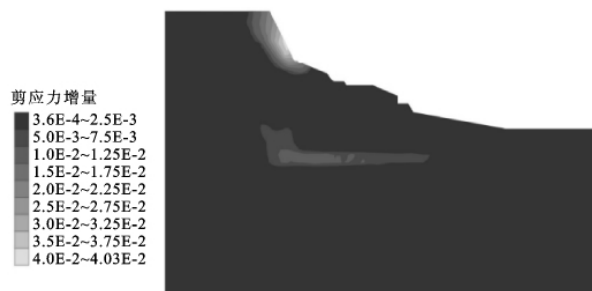
图 7 金顶寺滑坡考虑地下水作用下剪应力增量云图
