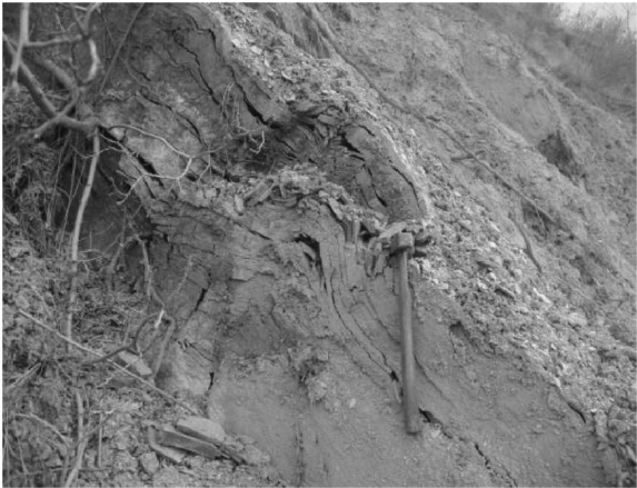
图 9 溃曲变形破坏模式
