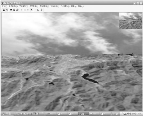
图 2 叠加正射影像纹理的三维效果
