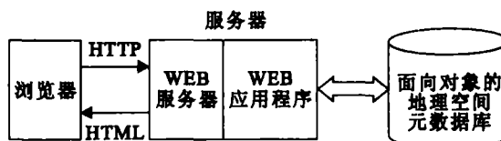
图 2 系统的 B/S 三层体系结构
