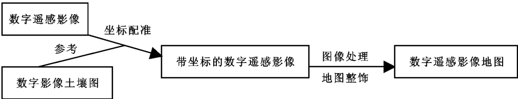
图 6 遥感影像地图制作流程
