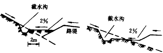
图 5 填方路段截水沟图
