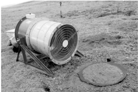
图 3 野外人工模拟风蚀试验装置
