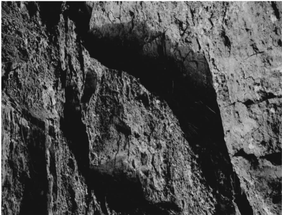
图 1 天然三趾马红土失水干缩裂隙
