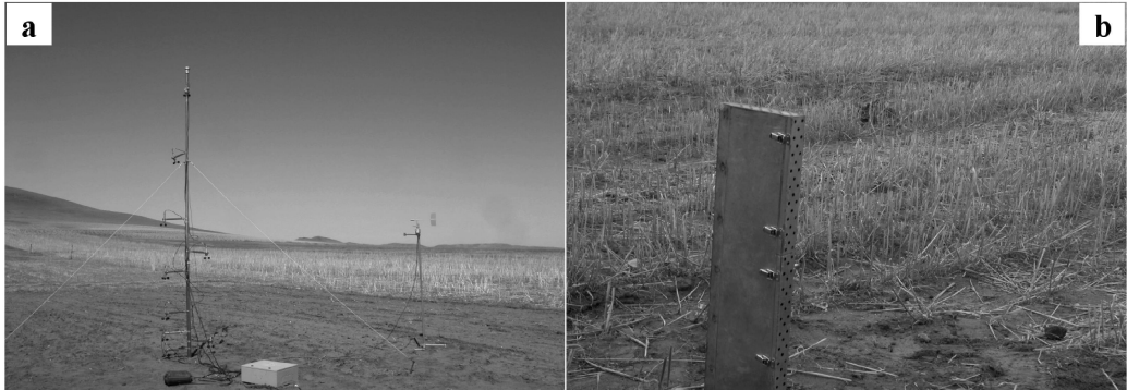
图 1 野外风沙观测: a、风速梯度仪 b、积沙仪
