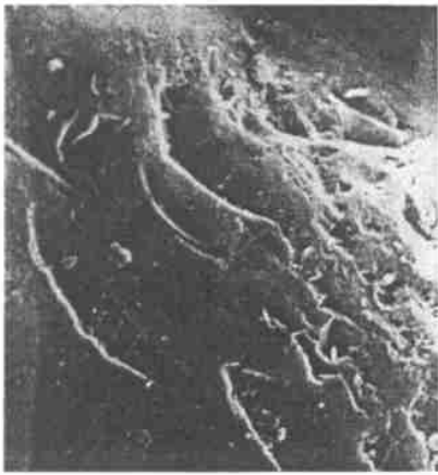
照片 15(756,6)金山咀西岸段 \times 2180 新月形、V 形撞击坑,坑内有少量的硅淀积物
