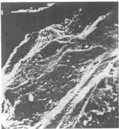
照片 16(16564)栈桥西岸段 10 \mu m 棱脊被磨蚀撞击,有平行解理,凹坑内溶蚀沟坑、鳞片状剥落
