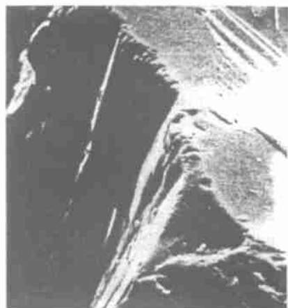
照片 4(16584)汤河口西岸段 20 \mu m 磨光面、具壳状断口、V 形坑
