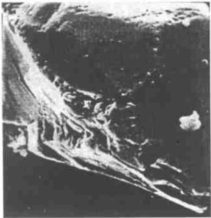
照片 7(16517)沙河口东岸段 5 \mu m 机械作用的形态组合
