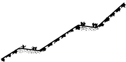
图1 水平阶隔坡草带
