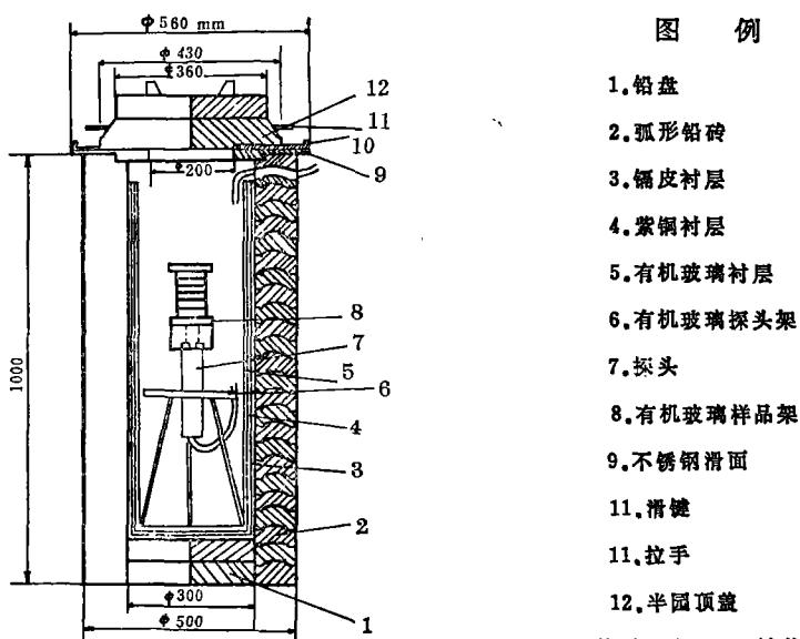
图1 屏蔽结构图 (单位: mm)
